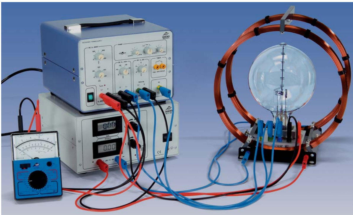
Fig. 2: Montaje experimental para la determinación de la carga específica del electrón
