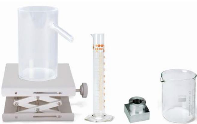
Fig. 1 Montaje para la determinación del volumen de un cuerpo de forma irregular
