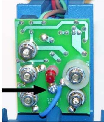
8) Se desatornilla el tornillo de fijación de la placa impresa. Cuidado, el tornillo se encuentra asentado en un anillo distanciador que no debe perderse.
