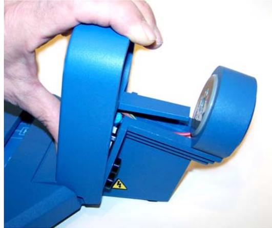
2) Se fija el pulgar debajo de la columna guía dejándolo trabajar como punto de palanca. Tirando levemente, se saca la travesa del casquillo del tubo.
