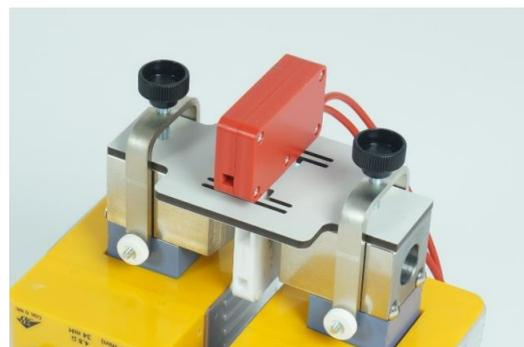
Fig. 1: Lámpara de cadmio montada en el electroimán.
