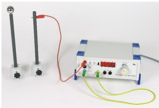
Fig. 3 Montaje para cargar la esfera
