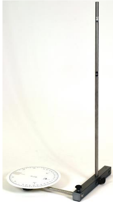
Fig. 3: Montaje de la varilla vertical.
