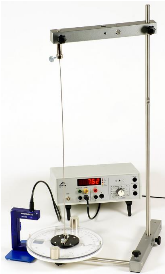
Fig. 10: Medición dinámica con una puerta fotoeléctrica y un contador digital.
