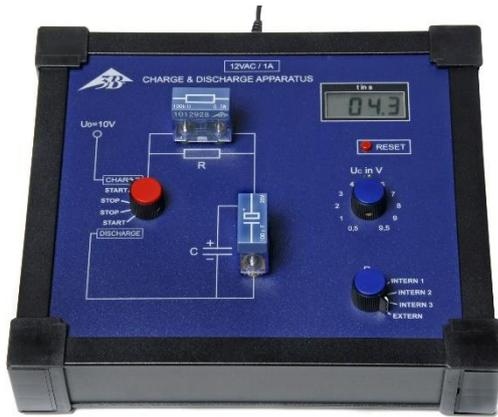
Fig. 1 Medición de combinación Resistencia / condensador externa.
