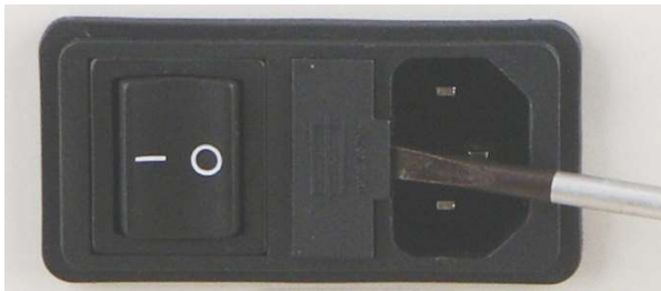
Fig. 3: Remplacement de fusible
