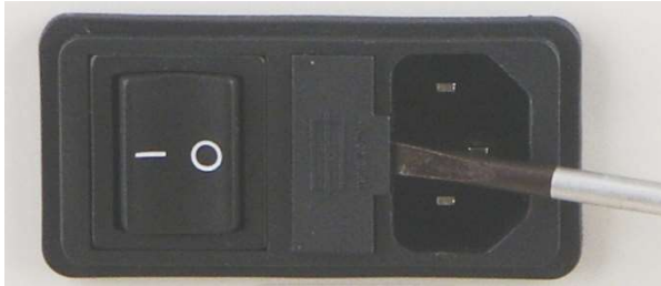
Fig. 3: Troca de fusíveis
