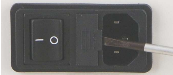
Fig. 3: Reemplazo de fusibles
