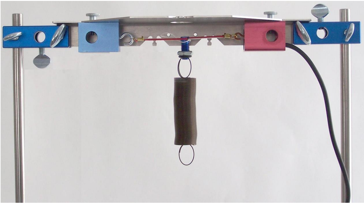
Fig.4 Montaje del travesaño en las varillas soporte
