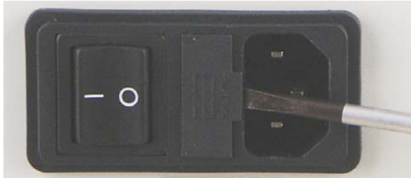
Fig. 3: Sostituzione dei fusibili
