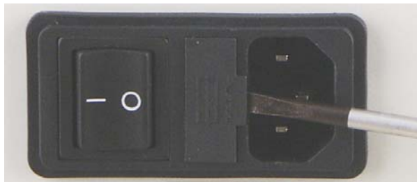
Fig. 3: Reemplazo de fusibles
