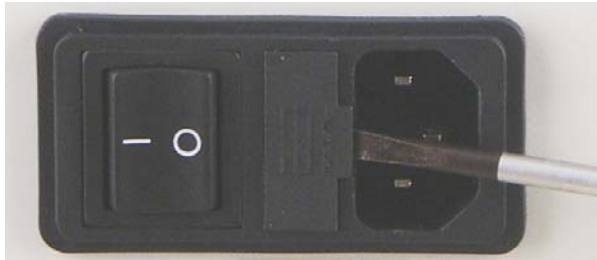
Fig. 3: Remplacement de fusible
