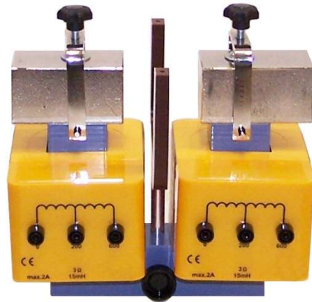
Fig. 4: Aufbau auf U-Kern mit Spulen, Polschuhen und U-Halter
