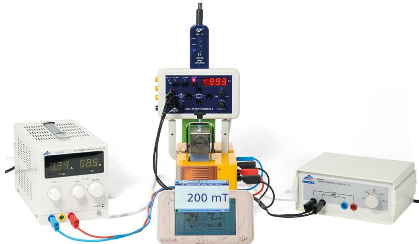
Fig. 9: Experimentieraufbau Hall-Effekt mit homogenem Magnetfeld
