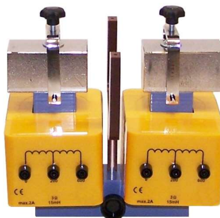
Fig. 4: Montaggio su nucleo a U con bobine, espansioni polari e supporto a U
