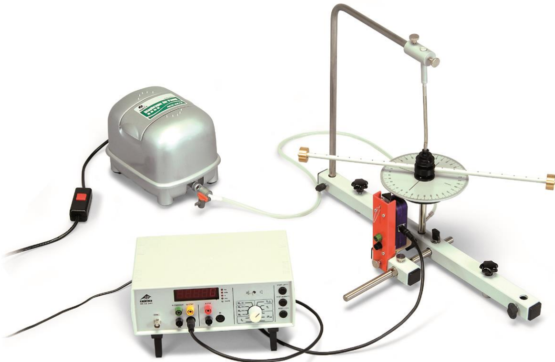
Fig. 2 Montaje experimental para la determinación del momento de inercia de una varilla de haltera con masas adicionales utilizando el sensor de reflexión de Láser (1001034) y el contador digital (1001032 o 1001033)
