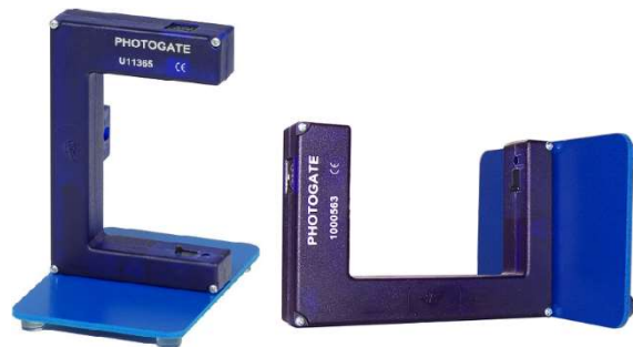
Fig. 3: Mit der Halteplatte z.B. im Experiment mit dem Torsionsgerät oder dem Reversionspendel
