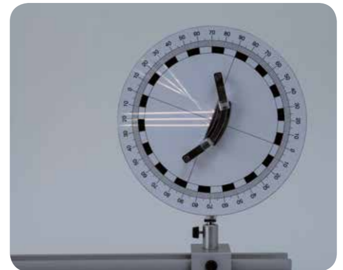
Fig. 3: Reflexión de tres rayos paralelos en un espejo cóncavo
